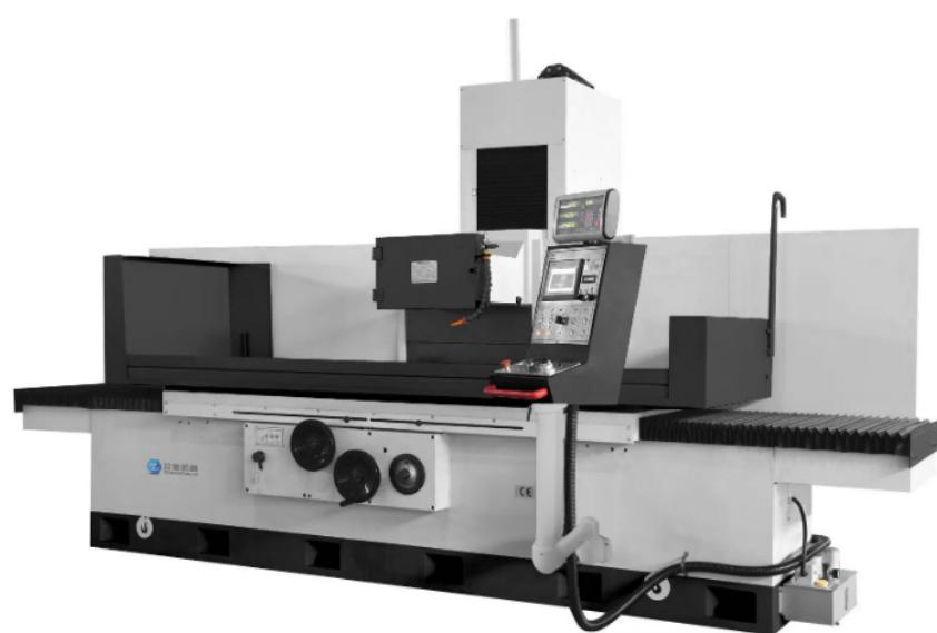
大型平面磨床的前期维护：1、磨床保养时需清洗冷却泵铁屑槽、水箱（组成部分：高水箱、存水箱、低水箱）并检查防冻冷却液，清洗并调整磨头及磨头镶条；2、需检查并调整压力阀的压力，还需检查各液压手柄和导轨是否很灵活；3、磨床的清洗机油、滤清器、磁盘、床面和导轨面、液压泵、管线及油路都要保养；4、还要巡查行程速度和导轨进油状况，紧固各部螺丝；5、之后巡查平面磨床内外各部件的清洁度，加上各些润滑油。平面磨床能加工淬硬钢、硬质合金等硬度相当高材质，也可以加工玻璃、花岗石等脆度较高的材料。使用数控平面磨床的工序的准备工时占有较高的比例。全国成型平面磨床售价
