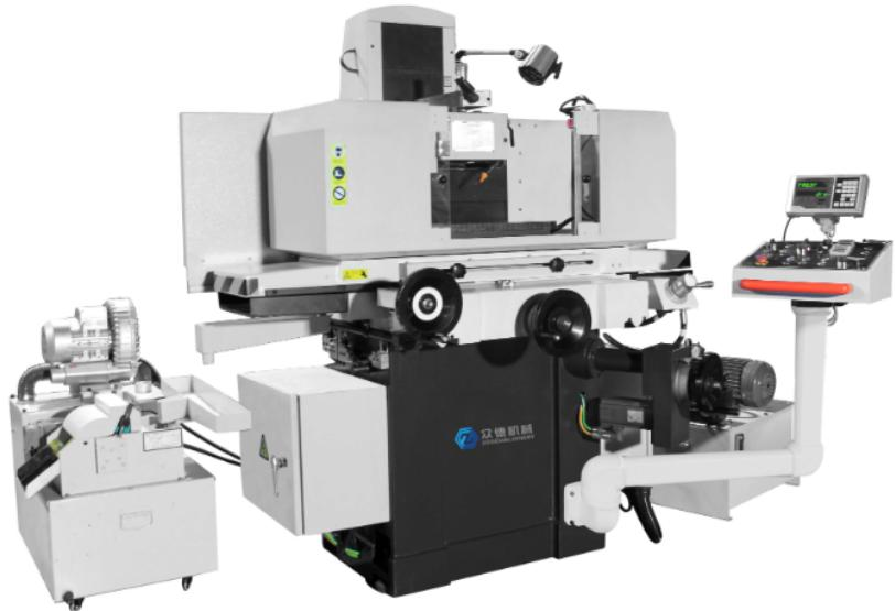
平面磨床主要结构特点：1) 高刚度高稳定性床身：床身采用整体花岗岩结构，由于花岗岩具有高阻尼、小振动、热稳定性佳等特性，可以保证磨床高刚度和高稳定性。2) 工作台：工作台面采用整体花岗岩结构，在传统闭式静压导轨的基础上开发了高刚性、高精度的大平面闭式静压导轨，以实现工作台的大行程、平稳、可靠的往复运动。工作台同时为了防止直线电机的运动影响台面，专门为直线电机设计了单独的静压导轨。3) 砂轮架：开发了转速范围广、高刚性、高精度砂轮静压主轴系统，以实现砂轮的高刚性、高精度回转运动。砂轮轴采用液体静压轴承支承，采用冷却液强制冷却主轴电机，砂轮主轴配备了砂轮平衡装置，配套的管理控制程序能在循环中连续监测砂轮的情况并立即对可能出现的不平衡量进行补偿。苏州平面磨床哪里好平面磨床是磨床的一种。
